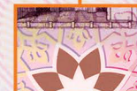
- مرکب ضد کپی بعد از گرفتن کپی رنگ این مرکب به قهوه ای تغییر می یابد.
